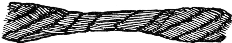
Рисунок 7. Перекручивание каната
